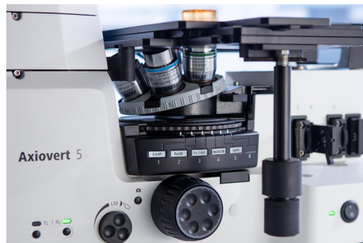
Flexibilität durch inverses Stativ mit 6-fach-Reflektorrevolver und 6-fach-Objektivrevolver
